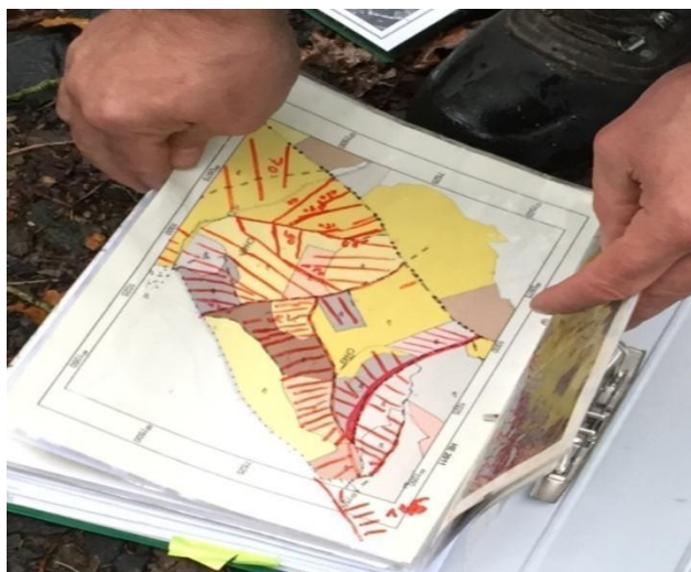
10. ábra. A terep változó kitettségéhez, lejtirányához igazított közelítőnyomok térképi rögzítése
